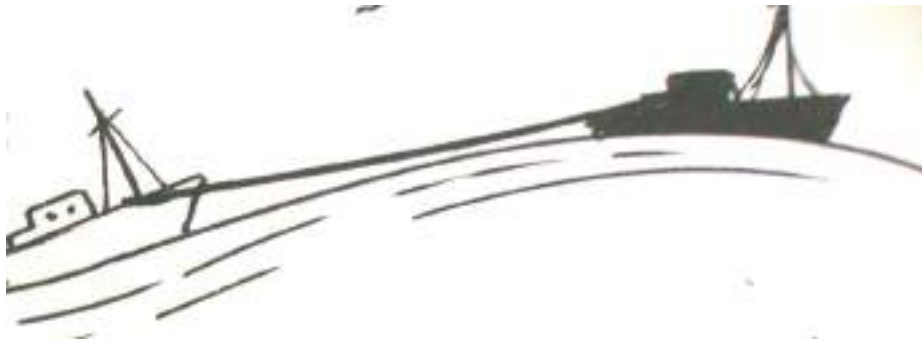
Reboque com o cabo demasiado curto
